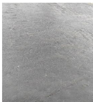
图 5 涂层成膜膜面合格
