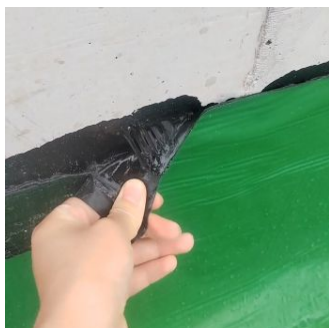
图 7 合格的非固化防水涂料与卷材粘接效果
