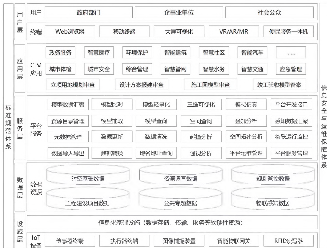
图 6.1.1 CIM 基础平台总体架构
