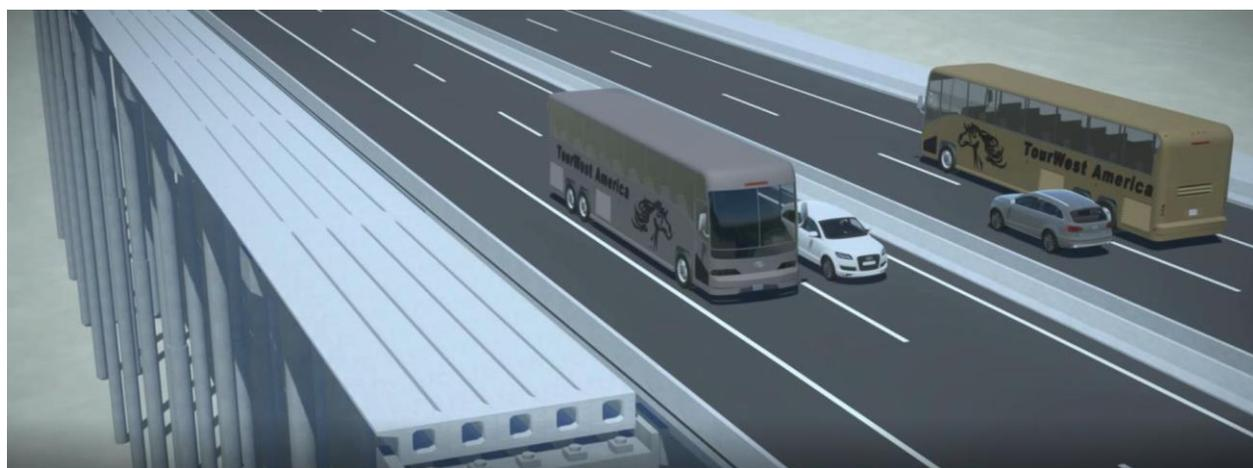
图 14. 10. 4-3 桥梁双侧拼宽保通示意
